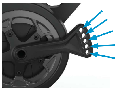
Réglage de la longueur de la manivelle
