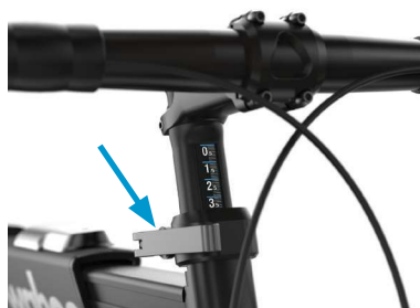
Regolazione altezza stack
