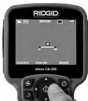
Rys. 14 - Regulacja diod LED
