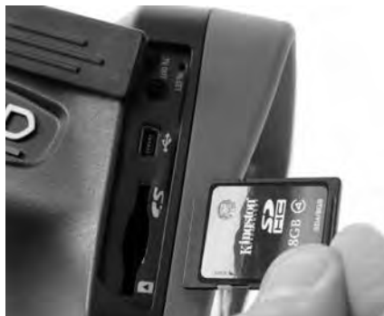
Εικόνα 9 - Εισαγωγή κάρτας SD
