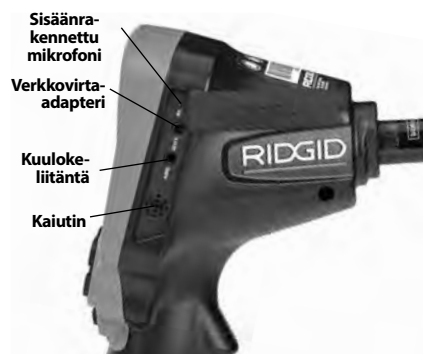
Kuva 3 – Oikean puolen portin suojus
