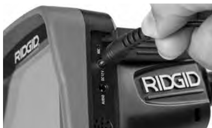
6-сурет – Құрылғыны айнымалы ток адаптерімен қуатқа қосу
