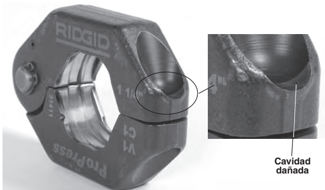
Figura 13 – Cavidad del aro dañada
