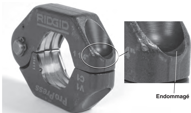
Figure 13 – Logement de bague endommagé
