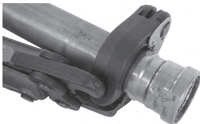
Figure 14B – Déviation de l'actionneur V2 dans les logements de bague XL-C pour faciliter l'accès
