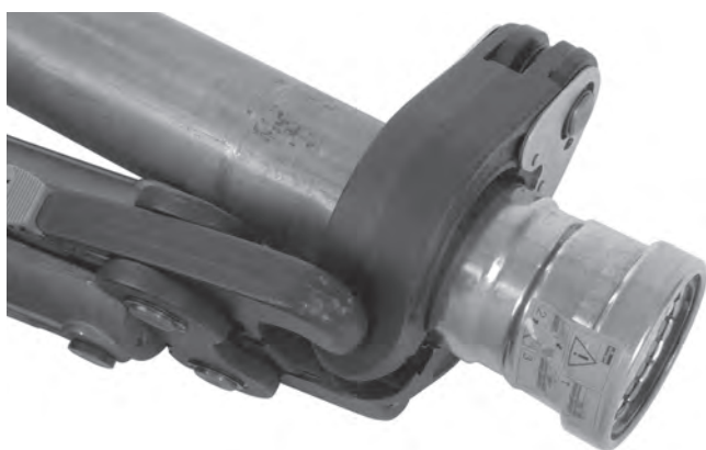
Figura 14B – Las puntas del accionador V2 colocadas, paralelamente al tubo, en las cavidades del aro XL-C para mayor maniobrabilidad
