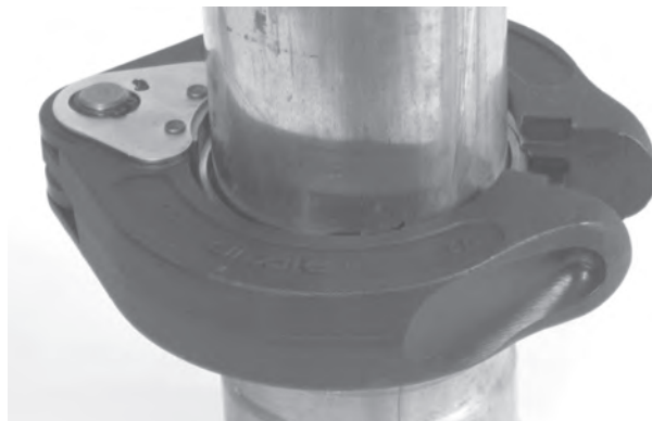
Figura 12A – Montaje del ProPress XL-C alrededor del acoplamiento
