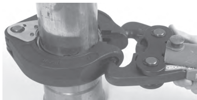
Figure 14A – Positionnement des embouts d'actionneur V2 dans les logements de bague XL-C
