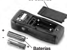
Figura 5 – Reemplazo de las baterías
