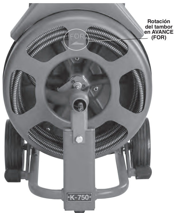
Figura 6 – Correcta rotación del tambor (conmutador en posición FOR)
