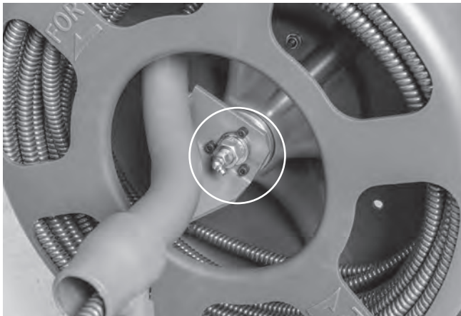
Figura 17 – Ubicación del acoplamiento de engrase
