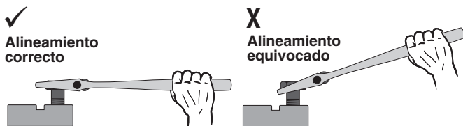
Figura 5 – Alineamiento correcto con la pieza trabajada
