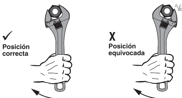
Figura 4 – Aplicación de fuerza correcta
