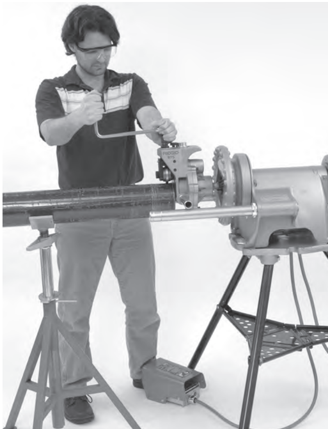
Figura 12 – Posición para la operación de la ranuradora a rodillos
