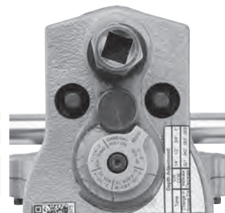
Figura 10 B – Calibre en la posición de ranurado
