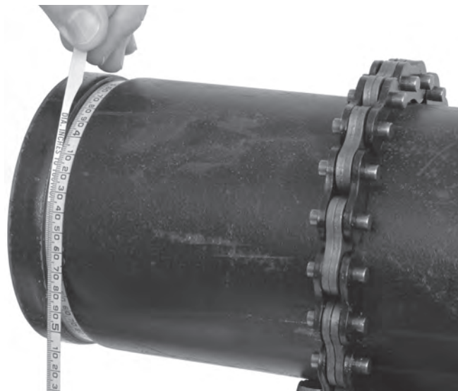
Figura 11 – Uso de una cinta de diámetros para medir el diámetro en la ranura
