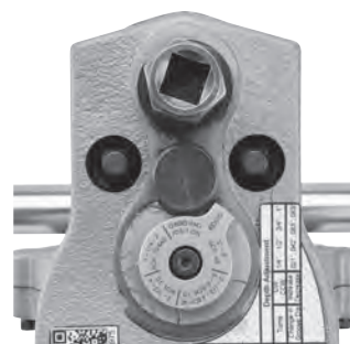
Figura 15 B – Calibre en la posición de ranurado
