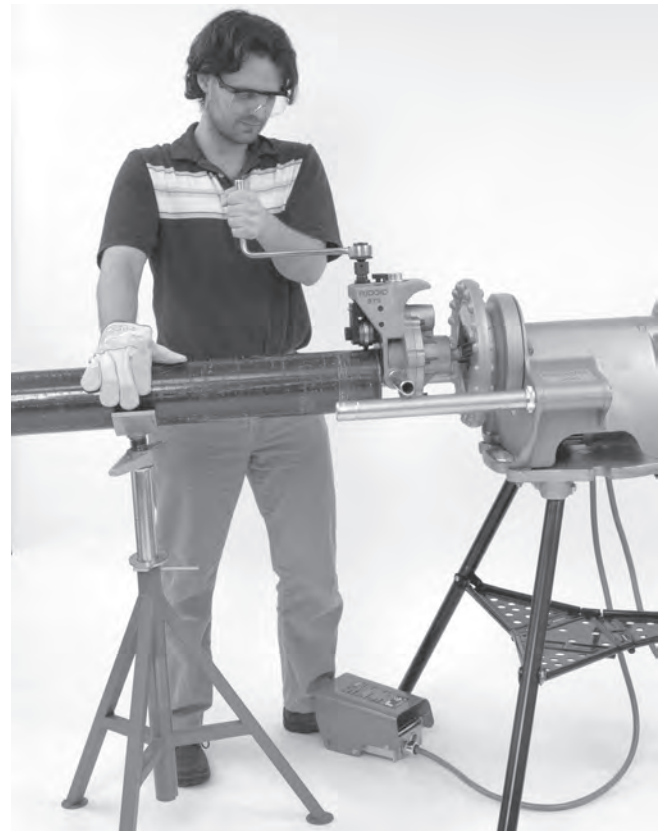
Figure 13 – Appuyer sur le tuyau en cours de rainurage pour maintenir son alignement
