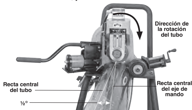
Figura 13 – Desviación del tubo en ½° (exagerado en la imagen)
