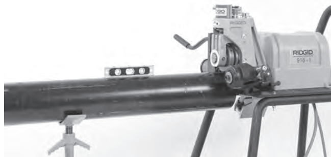
Figura 12 – Nivelación del tubo
