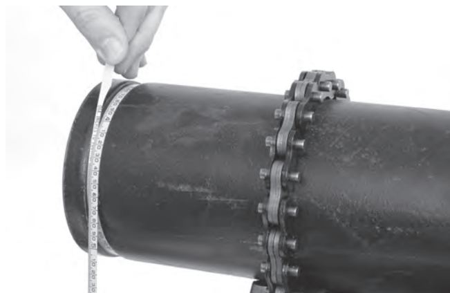
Abbildung 18 - Prüfen des Nutdurchmessers mit einem Durchmesserband
