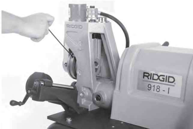
Abbildung 21 - Lösen der Stellschraube der Nutrolle
