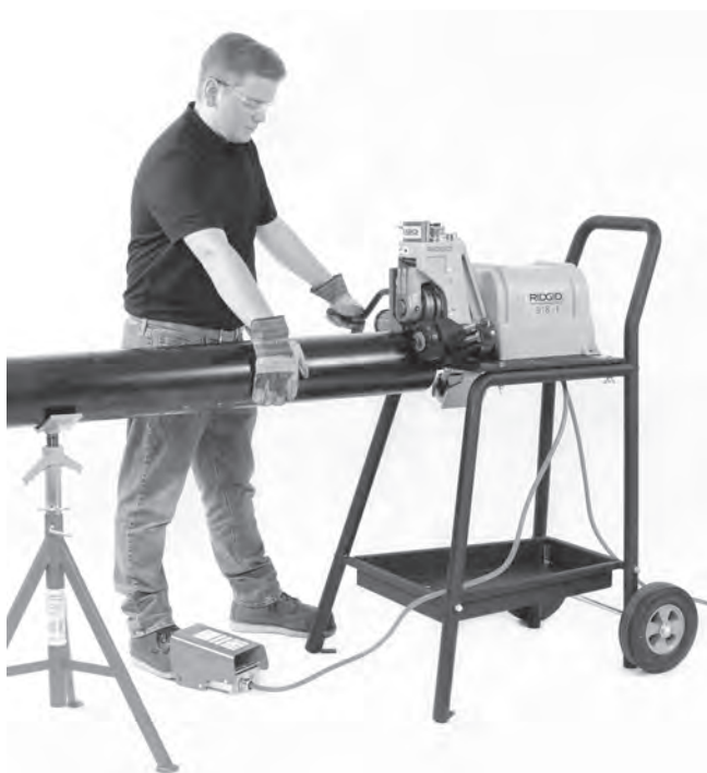
Abbildung 17 – Ausüben von Druck am Rohr
