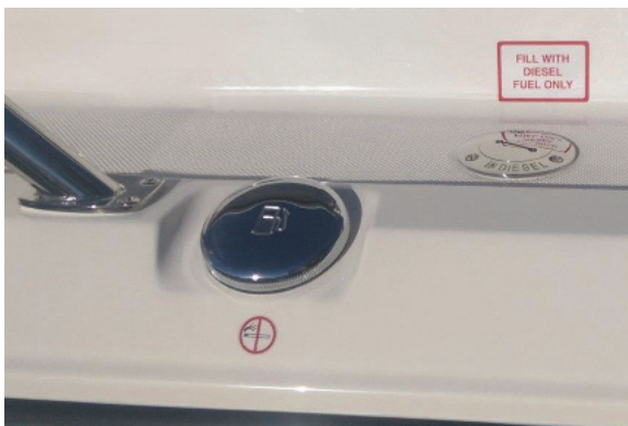
EPA Fuel Fill & Diesel Fill
