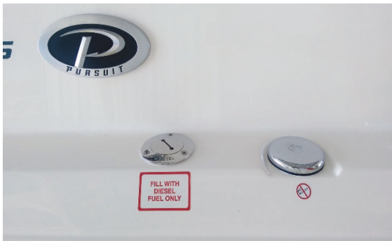
EPA Fuel Fill & Diesel Fill
