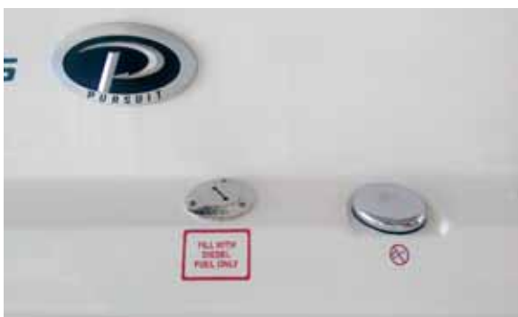
EPA Fuel Fill & Diesel Fill
