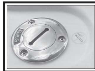
Gas Fuel Fill
