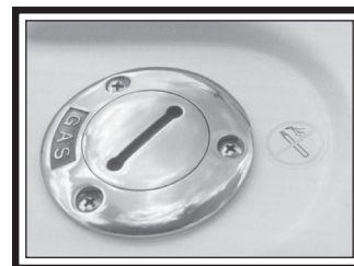
Gas Fuel Fill
