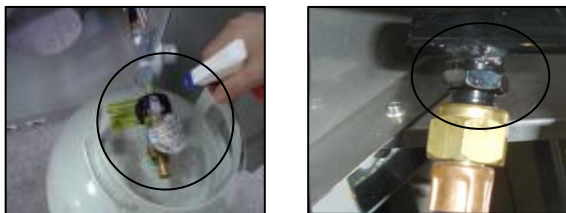
Vérification de fuites dans les joints de gaz
