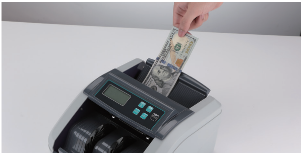
Figure 6-2 Réglage de l'écart d'alimentation avec un billet
