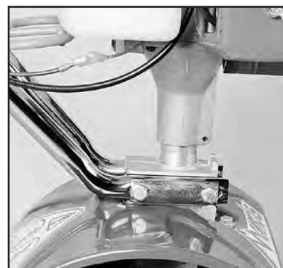
Figure 1 ... Remarquer la façon dont le moteur n'est pas parfaitement calé sur la transmission.
