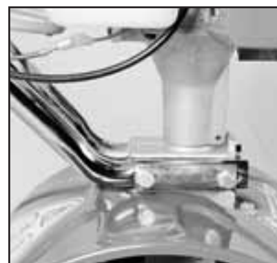
Ilustración 2 Nótese cómo el motor está apoyado totalmente sobre la transmisión helicoidal.
