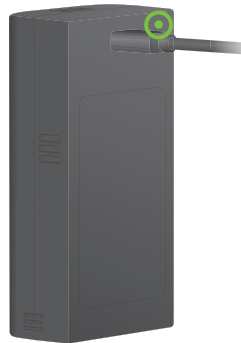
Verde: batería completamente cargada
