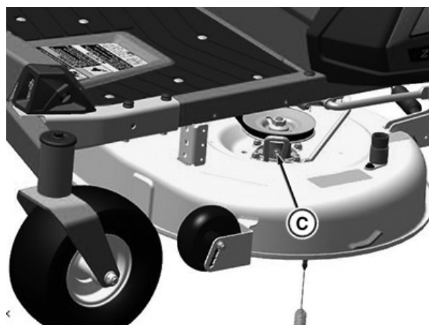
Borttagning av vänster spindelskydd
