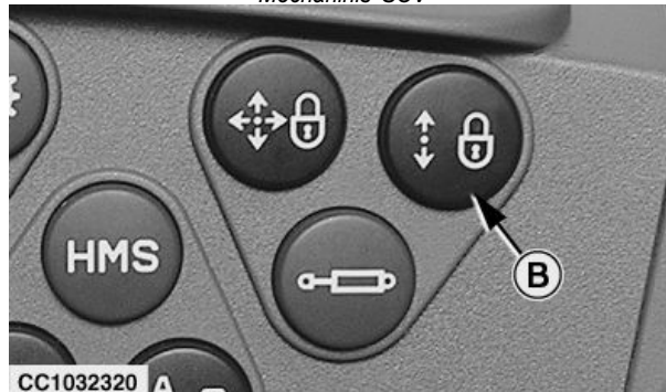
Elektriniu būdu įjungiamas SCV
