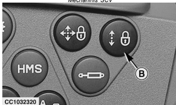
Elektriniu būdu įjungiamas SCV
