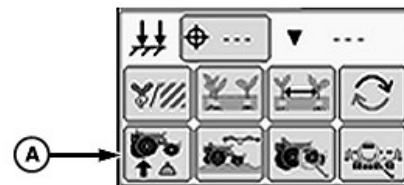
Bouton Pression au sol (pression au sol pneumatique à point de consigne unique)
