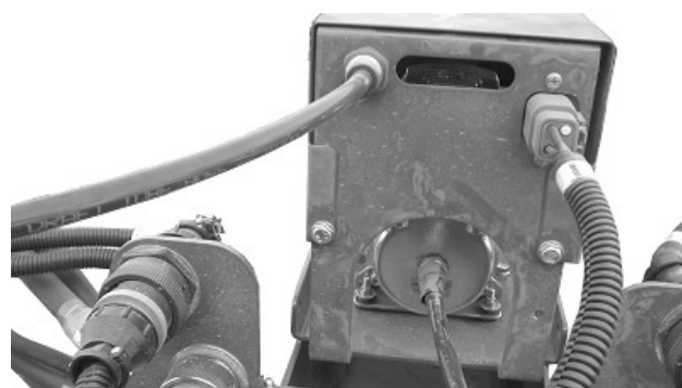
APY01359—UN—11DEC17 Compresseur d'air (pression au sol à point de consigne unique)
