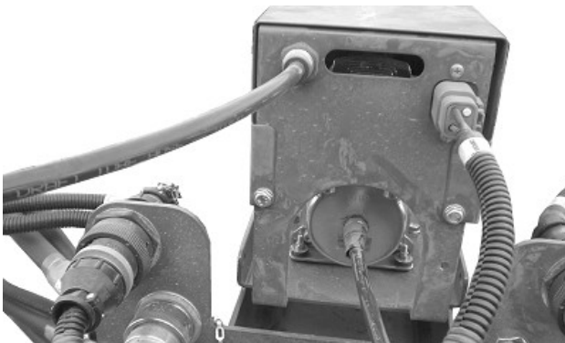
Compresseur d'air de pression au sol pneumatique (machines avec pression au sol pneumatique intégrée et point de consigne unique)
