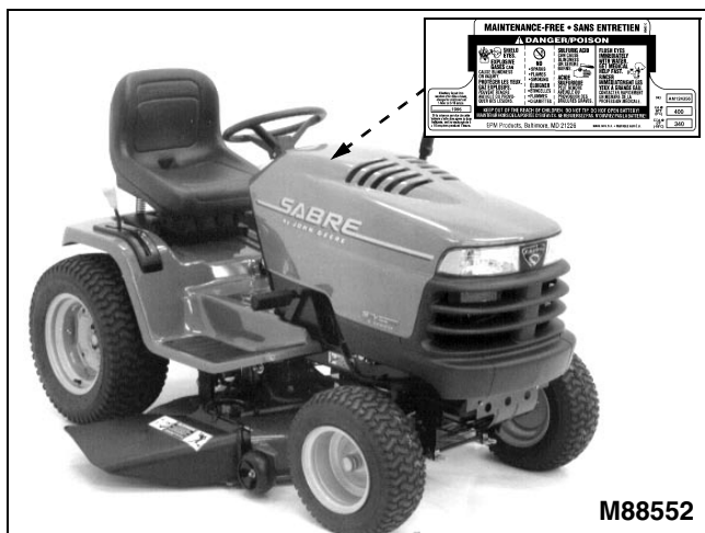
Photo : Autocollant apposé sur la batterie
