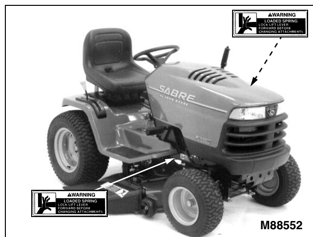
Photo : Un autocollant de chaque côté du châssis du tracteur
