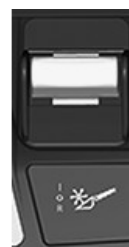
Innkobling av skjærebord
