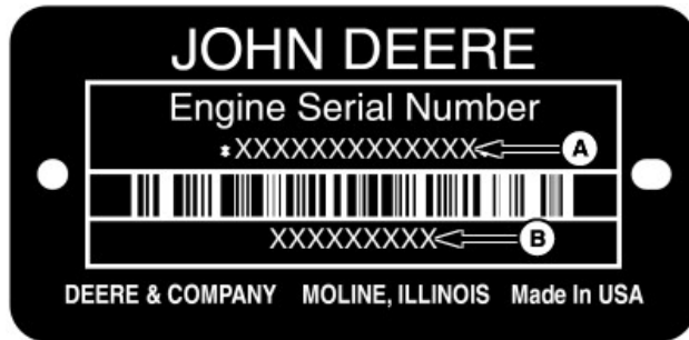
Chapa del número de serie del motor de muestra
