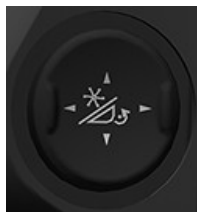
Elevación/descenso del molinete, ajuste longitudinal del molinete
