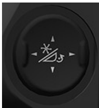
H116349—UN—19DEC16 Ridicarea/coborârea rabatorului, mecanismul de reglare înainte/înapoi a rabatorului
