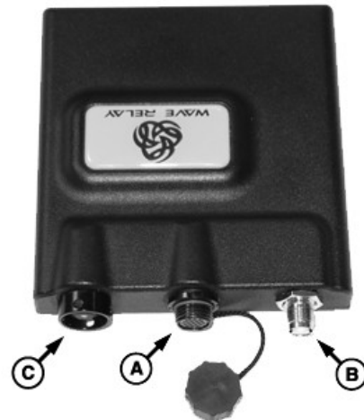
A—Живлення/дані (Ethernet) B—Антенa (коаксіальна) C—Світлодіод
