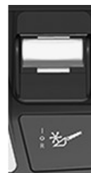
Реверс наклонной камеры
