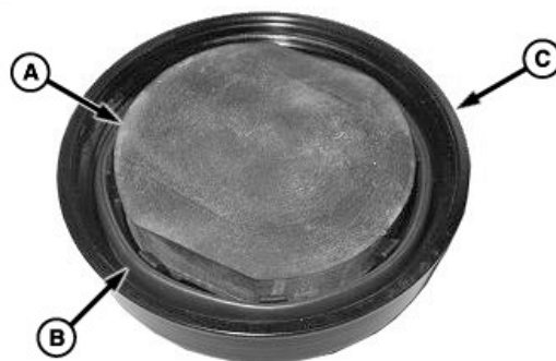
A—Прокладка из пеноматериала B—Уплотнение C—Крышка фильтра
