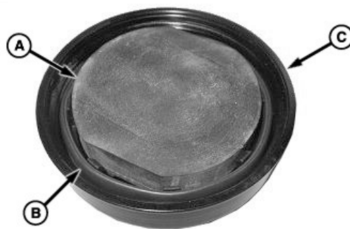
A—Прокладка из пеноматериала B—Уплотнение C—Крышка фильтра
