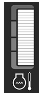
Указатель температуры охлаждающей жидкости двигателя
