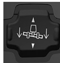
Двухпозиционный выключатель подъема/опускания жатки
