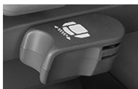
Рукоятка регулятора гасителя поперечных колебаний
