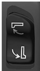
H117003—UN—22DEC16 Interruttore coclea di scarico
