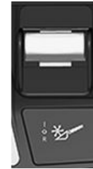
Реверс наклонной камеры
