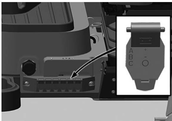
Gruppo di prese elettriche ausiliarie
