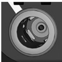
Presa elettrica ausiliaria
