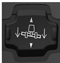
Spínač zdvíhanie/spúšťanie žacieho valu
