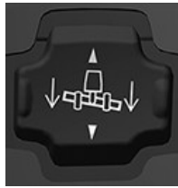
Spínač zdvíhanie/spúšťanie žacieho valu
