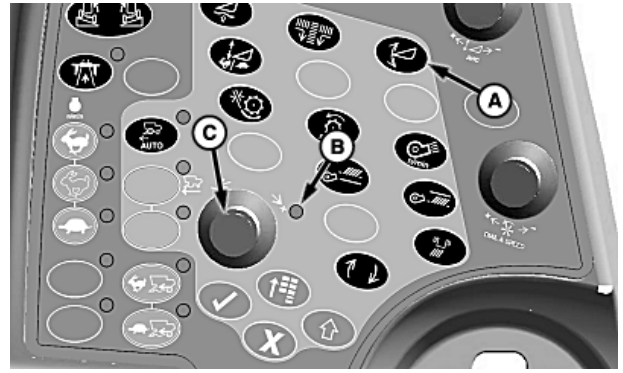
A—Interruptor de ajuste de inclinación de la barra de corte de la trilladora B—Luz indicadora
