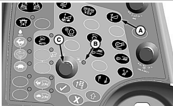
A—Tecla de Plegado/Desplegado del cabezal de maíz B—Luz indicadora C—Dial de selección
