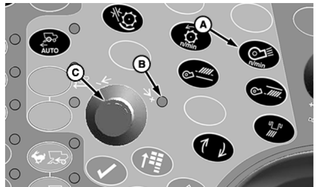
A—Interruptor de ajuste de la velocidad del ventilador de limpieza B—Luz indicadora
