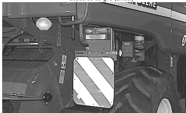
Luces de posición traseras (rojas) y luces de advertencia/indicadores de giro (ámbar)
