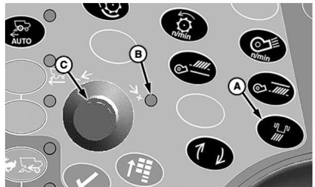
A—Tecla de ajuste de los deflectores del picador B—Luz indicadora C—Dial de selección
