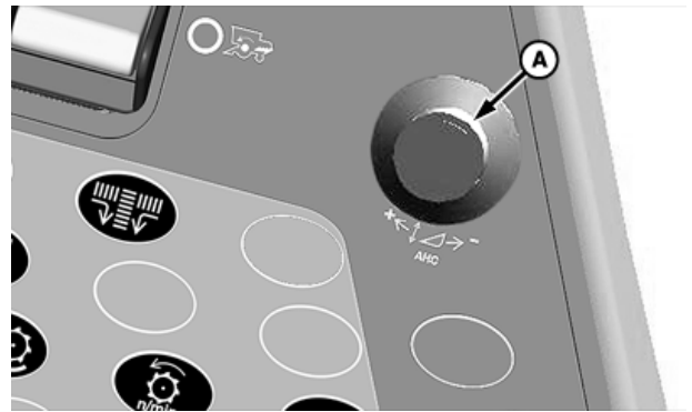
A—Dial de control de la presión del HydraFlex/Altura del cabezal de corte
