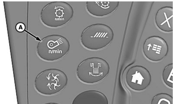
A—Puhastusventilaatori pöörlemissageduse reguleerimise lüliti
