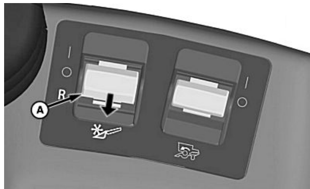
A—Heedri aktiveerimise ja kaldtransportööri reverseerimislülitit
