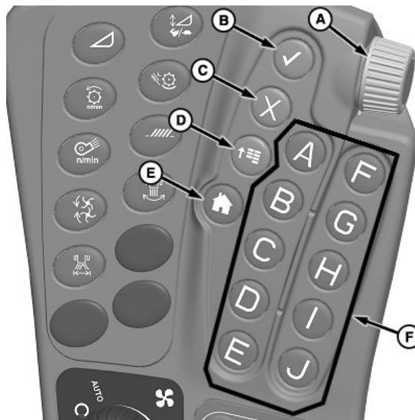
A—Valikunupp B—Kinnitamise lüliti C—Tühistamise lüliti
