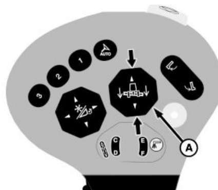
A—Heedri tõstmise/langetamise lüliti
