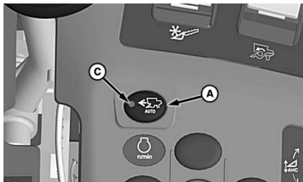
A—Harvest Smart™-i etteandekiiruse aktiveerimislüliti
