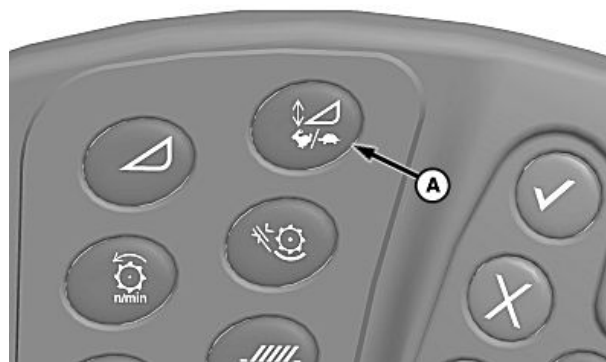
A—Kaldtransportööri kiiruse/tundlikkuse reguleerimise lüliti
