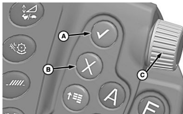
A—Kinnitamise lüliti B—Tühistamise lüliti
