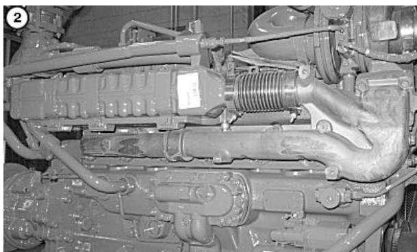
(2) – väljalaskekollektor ja kollektori kaitsekate, turbo vahetoru, heitgaaside ringluse (EGR) jahuti toru
