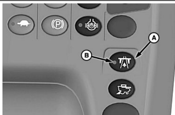
A—Comutatorul de deconectare a transportului pe drum
