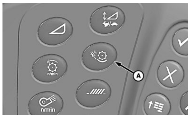
A—Spínač nastavenia vôle mlátiaceho bubna
