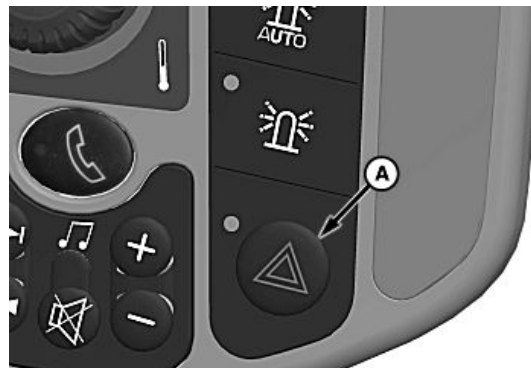
A—Spínač majáka/svetiel výstražnej signalizácie
