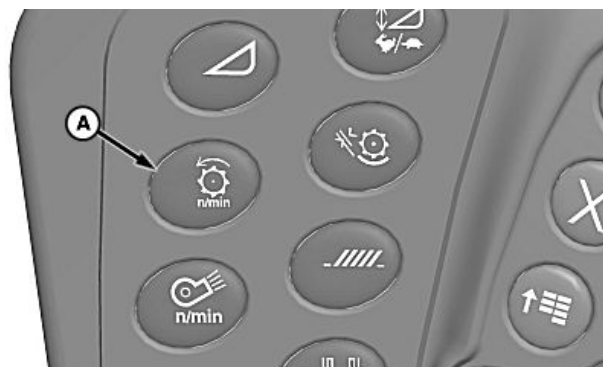
A—Spínač nastavenia otáčok mlátiaceho bubna
