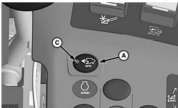
A—Spínač aktivácie systému rýchlosti podávania Harvest Smart™ B—Režimy prevádzky C—Kontrolka
