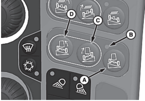
A - مفتاح التحكم الأوتوماتيكي في المستوى B - ضوء المؤشر C - مفتاح اليمين للميل اليدوي D - مفتاح اليسار للميل اليدوي
