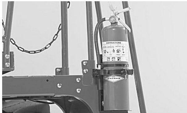
Eesmise tulekustuti asukoht
