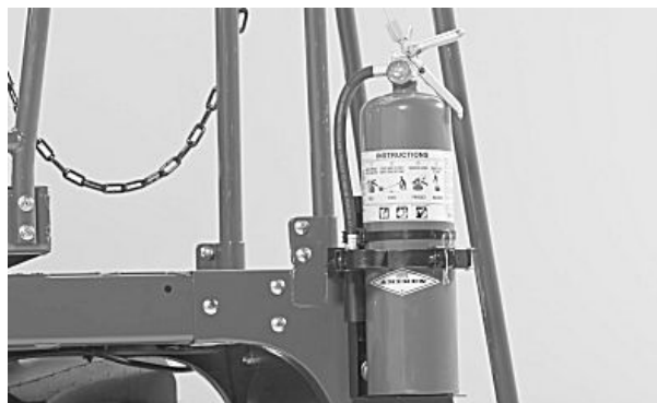
Umiejscowienie gaśnicy z przodu
