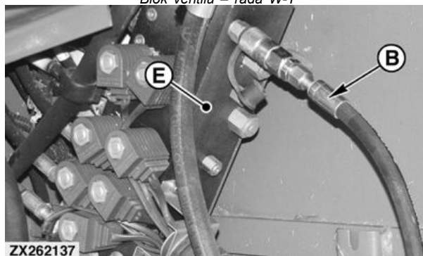
Blok ventilů – S670
