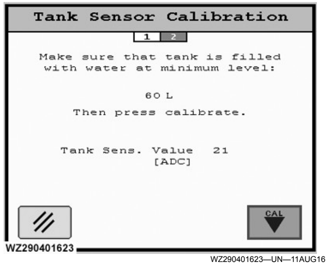
Минимальный уровень бака — шаг 2, для калибровки R700i используйте 60 л
