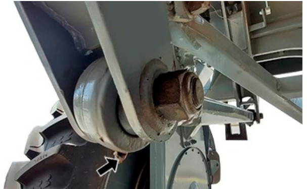
Rótulas del tensor (20 puntos de engrase, 2 por tensor)
