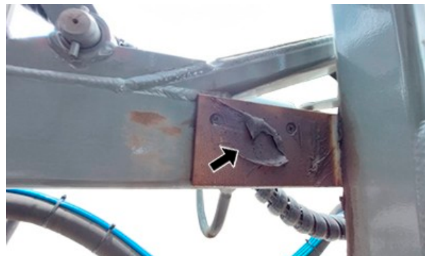
Placas de posición superiores de la estructura de oscilación (2 puntos de engrase, 1 a cada lado)—Solo pulverizadores autopropulsados 2900
