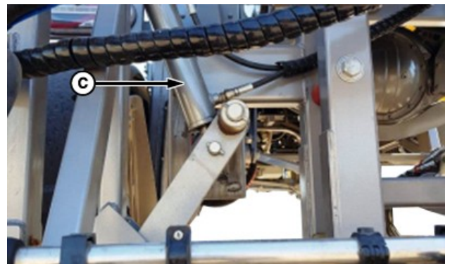
Cilindro de bloqueo—Retraído (posición de desbloqueo)
