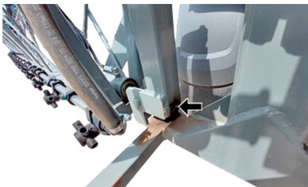
Estructura de articulación inferior del bastidor central (2 puntos de engrase, 1 a cada lado)
