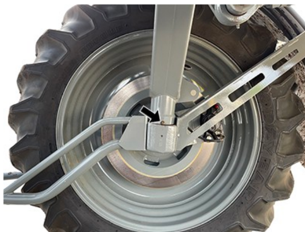
Extremos inferiores del eje delantero—Lado interior (2 puntos de engrase, 1 a cada lado)
