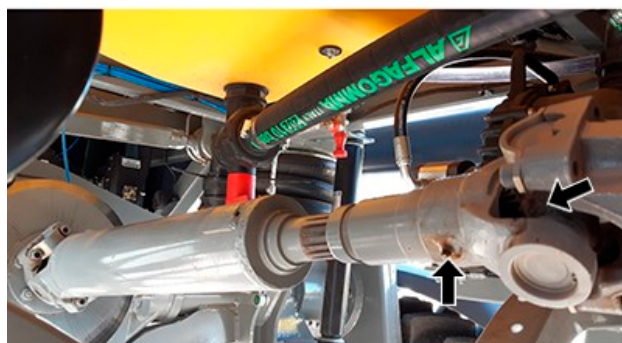
Extremo del eje de transmisión y varilla estriada (2 puntos de engrase)—Máquinas equipadas con motor central
