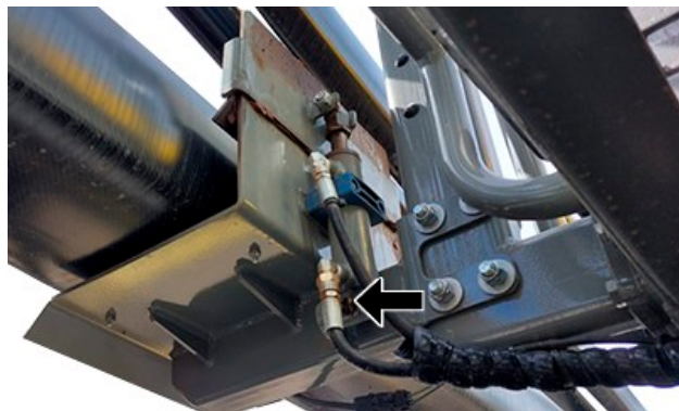
Cilindros de bloqueo de la barra de pulverización (dos puntos de engrase, uno a cada lado)
