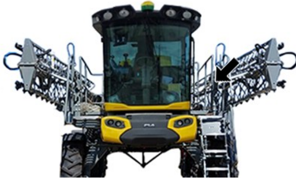
Ubicación del amortiguador de la puerta de la cabina
