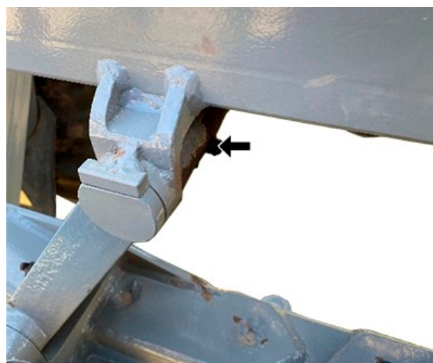
Vástago de oscilación—Pulverizador autopropulsado 2900 (4 puntos de engrase, 2 en cada vástago)
