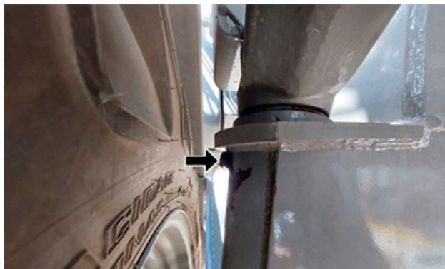
Extremos superiores del eje delantero—Lado exterior (2 puntos de engrase, 1 a cada lado)
