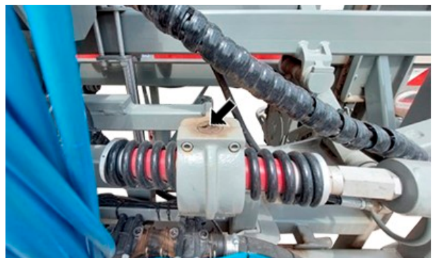
Cilindro de bloqueo de oscilación (1 engrasador)—Solo pulverizadores autopropulsados 2900
