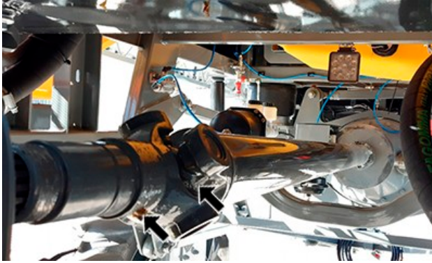
Extremo del eje de transmisión y varilla estriada (2 puntos de engrase)—Máquinas equipadas con motor delantero
