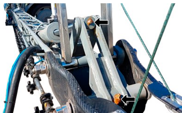
Articulación de sección exterior de la barra de pulverización —Lado exterior (4 puntos de engrase, 2 a cada lado)
