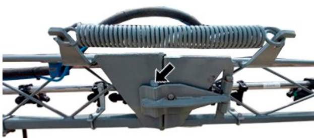
Bloqueo de seguridad de la barra de pulverización (2 puntos de engrase, 1 a cada lado)
