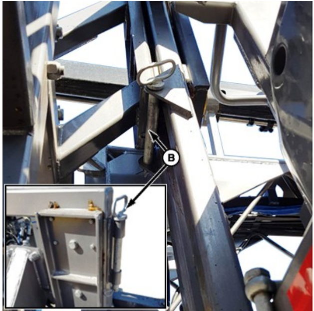
Bloqueo de transporte—Bastidor central
