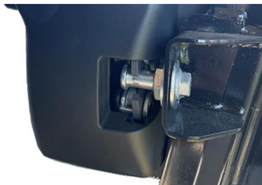
YE1388612—UN—10JAN25 Puerta no completamente bloqueada (Incorrecto)
