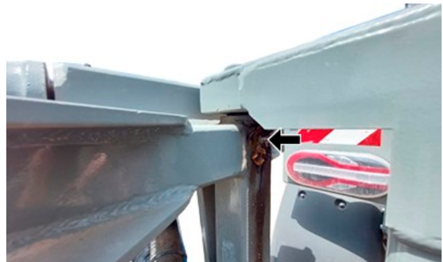
Estructura de articulación superior del bastidor central (2 puntos de engrase, 1 a cada lado)
