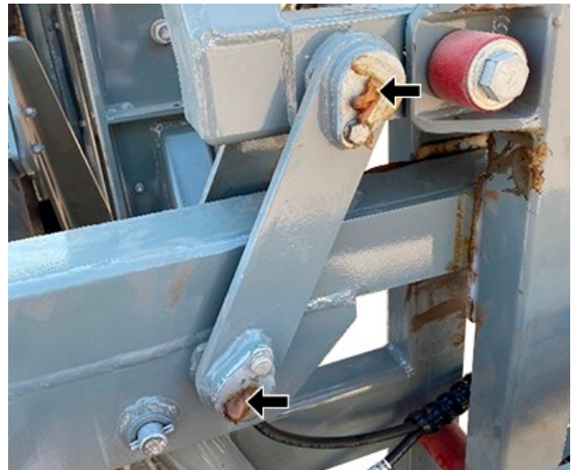
Vástago de oscilación—Otros modelos de máquina (4 puntos de engrase, 2 en cada vástago)
