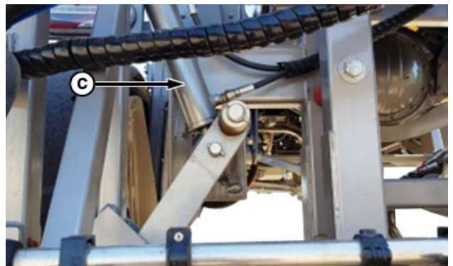
Cilindro de bloqueo—Retraído (posición de desbloqueo)
