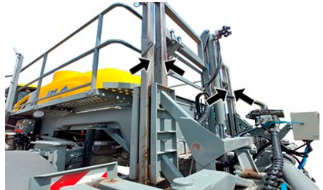
Estructura del bastidor central (4 puntos de engrase, 2 a cada lado)
