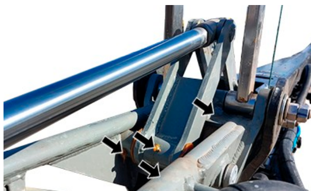
Articulación de sección exterior de la barra de pulverización —Lado interior (8 puntos de engrase, 4 a cada lado)
