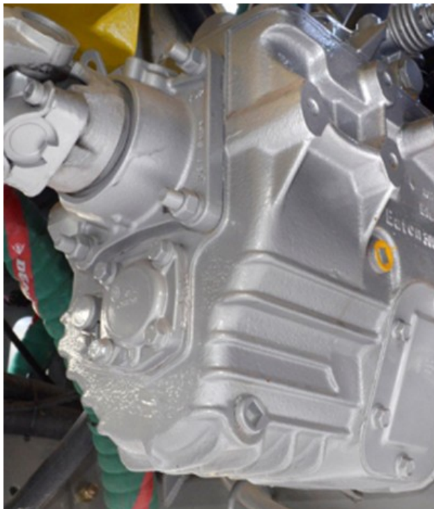
Transmisión Eaton FS 4205 - Máquinas mecánicas manuales
