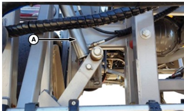
Cilindro de bloqueo—Retraído (posición de desbloqueo)
