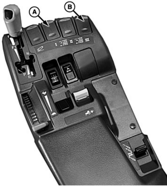
A—Рычаг управления селективным контрольным клапаном (SCV) 1 B—Рычаг управления селективным контрольным клапаном (SCV) 3
