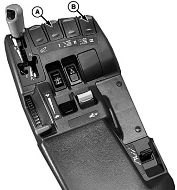
A—คันควบคุม SCV 1 B—คันควบคุม SCV 3
