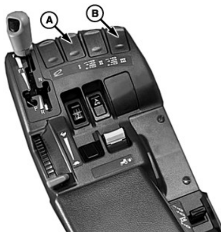
A—Leva di comando distributore idraulico 1 B—Leva di comando distributore idraulico 3
