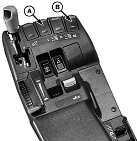
A—Lever de commande du distributeur auxiliaire 1 B—Lever de commande du distributeur auxiliaire 3
