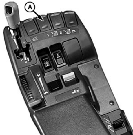
A—Lever de commande du distributeur auxiliaire 1
