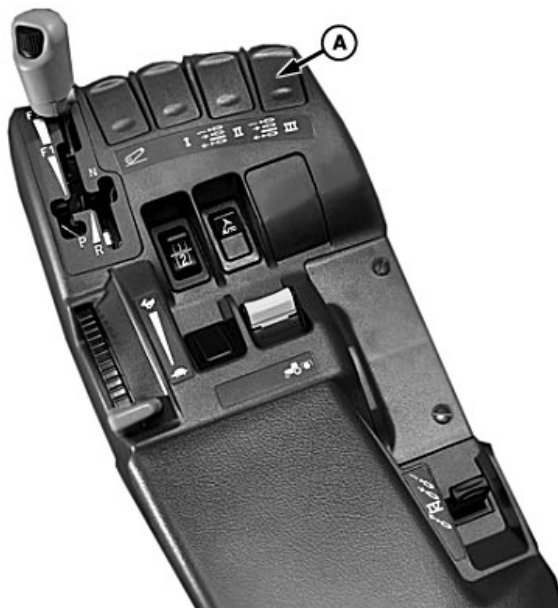
A—Alavanca de Controle da VCR
