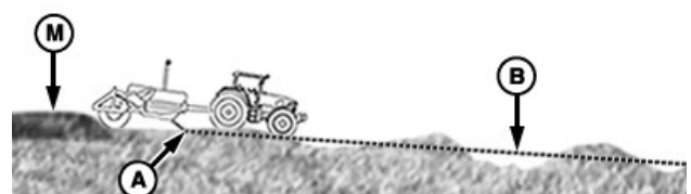
Drainage von vorhandenem Fahrweg weggleiten
