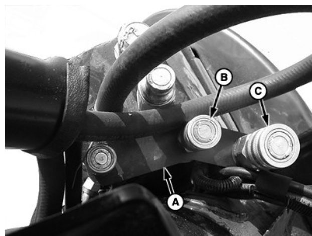
A—Кронштейн муфты B—Муфта привода полотенного транспортера C—Муфта привода ножа
